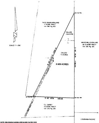
NOTE: BEARINGS SHOWN ARE BASED ON RECORD DEED CALL ON THE WEST BOUNDRY LINE OF THE MAVIS MILLS ROLLING TRACT
